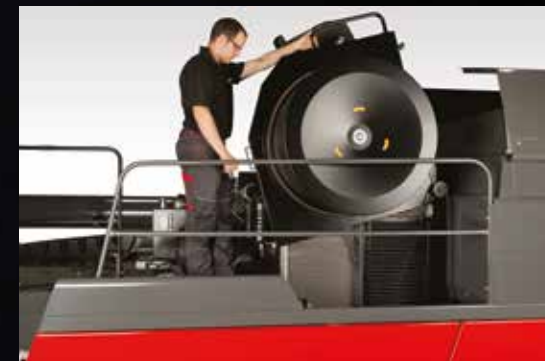
A hűtőradiátor a tisztítás érdekében könnyen hozzáférhető
