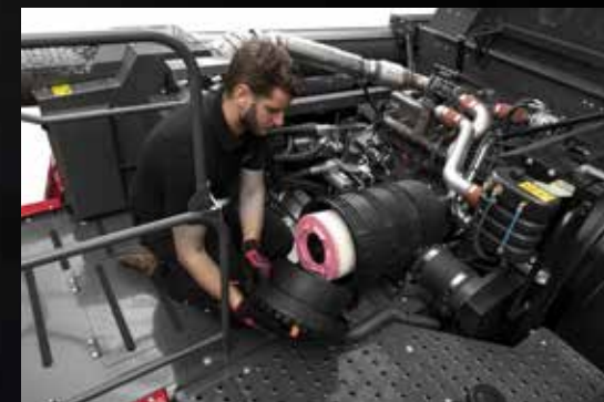
A levegőszűrő ellenőrzése és tisztítása
