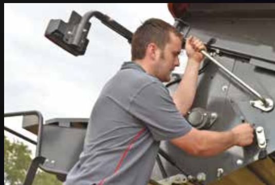
Egyszerű áttállítás szalmaszecskázásról rendrakásra
