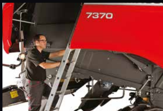
A motortér és a magtartály egy levehető létra segítségével biztonságosan megközelíthető
