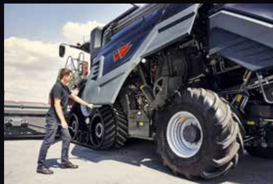
Egy darabból álló, világítással rendelkező oldalpanelek biztosítanak gyors és kényelmes hozzáférést a géphez ellenőrzés céljából
