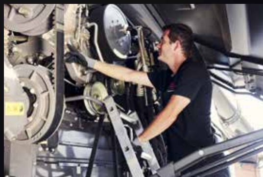
Egyszerűsített erőátvitel kevés szíjjal és láncsal
