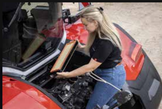
A fülke légszűrője könnyen hozzáférhető a tisztítás céljából történő kiszereeléshez.
