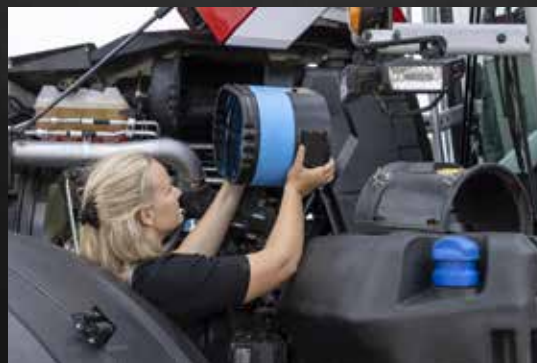
A motor légszűrője könnyen hozzáférhető és tisztítható.
