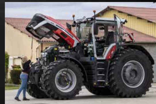
A mellső híd és a „karcsúsított” motorháztető kialakításának köszönhetően az olajsínt-ellenőrző nivópálca és a szűrő is könnyen hozzáférhető.
