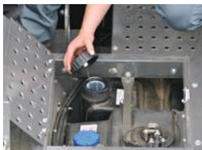
Könnyű tankolás – a két tartály a könnyebb hozzáférés érdekében egymás mellett található
